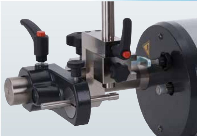
CG 측정용 악세서리 세트(타입 C) 주문번호 02ASU162 장착 예
