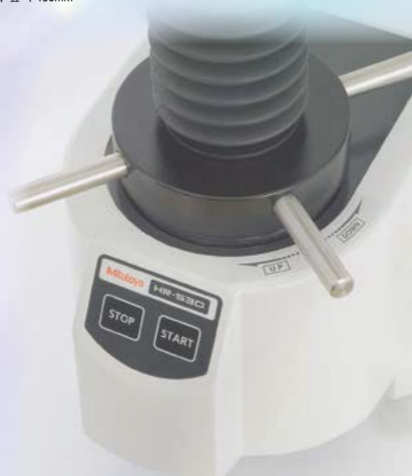
주문번호 No.810-331/-336 HR-530L • 최대 시료 치수: 높이 395mm, 깊이 150mm
