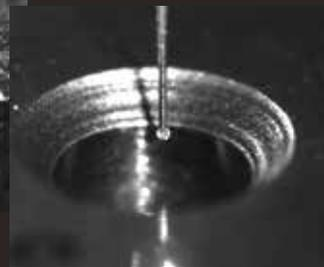
마그넷 방식을 통한 키네마틱 조인트를 사용하여 다른 스타일러스로 손쉽게 교체할 수 있습니다. 스타일러스 교체 공구(MPP-NANO 스타일러스 툴 셋)가 표준 탑재됩니다.
