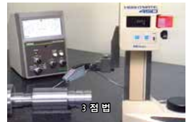
다이얼 게이지나 전기 마이크로미터와 V블록 등에 의한 3점법
